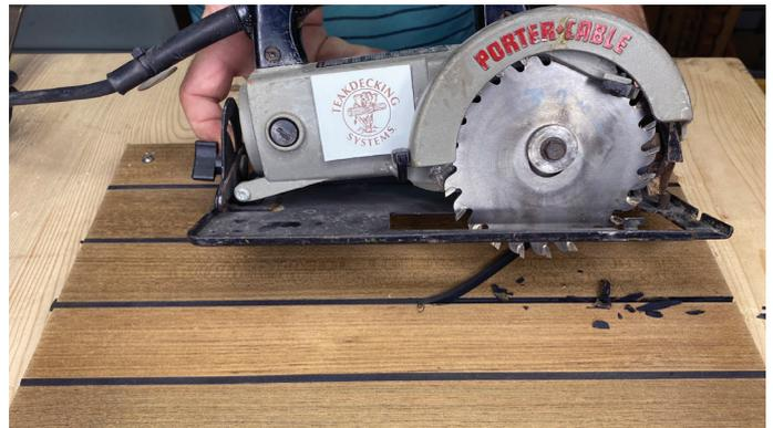
4. Hinweis: Eine Fugen- oder Nutsäge kann insbesondere bei geringen Anforderungen an die Fugentiefe verwendet werden. Die Schutzkappe der Säge sollte vor dem Gebrauch aufgesetzt werden (auf dem Foto wurde die Kappe entfernt, um das Blatt zu zeigen).
