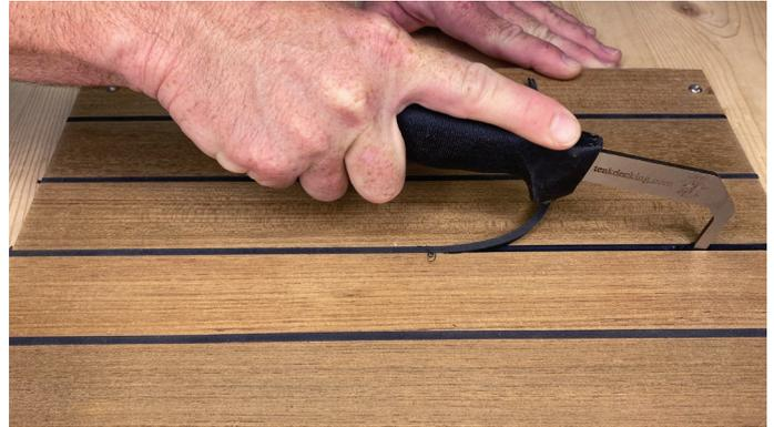
2. Mit einem Ausfughaken kann die mit der Klinge gelöste Fugenmasse ausgekratzt werden, so dass minimale Rückstände einfach weggeschliffen werden können.
